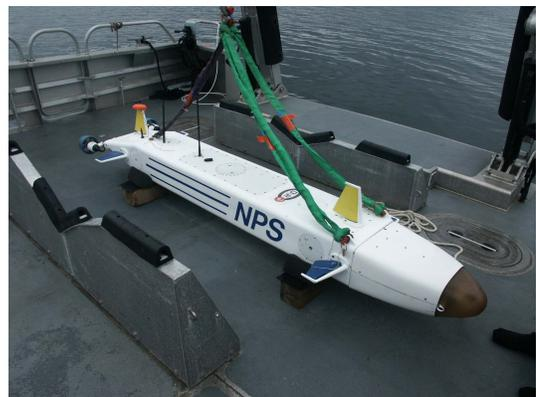
Fig. 1. NPS ARIES AUV
